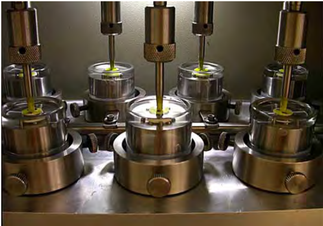
FIGURA 8 - Vista frontal da amostra cerâmica em momento de ensaio de fadiga mecânica, evidenciando o posicionamento das fitas adesivas amarelas entre a superfície da cerâmica e a haste metálica da cicladora mecânica (água, 37°C).
