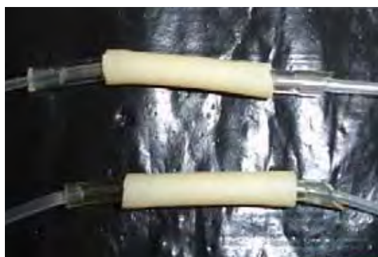
Figura 38. Foto do sistema de FIA acoplado a EFS. a) Foto do sistema mostrando a seleção da amostra pela alça de amostragem que na seqüência passa pela minicoluna e após limpeza e eluição conflui com a solução reagente e atinge o detector; b) Destaque para a posição de inserção da minicoluna no sistema FIA; c) Minicolunas construídas para a EFS.
