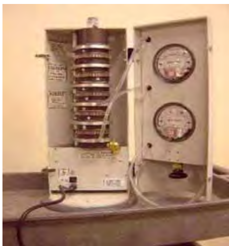
Figura 10. Impactador de cascata (tipo MOUDI) para especificação por tamanho do material particulado.
