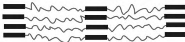
Figura I.6 – Esquema representativo do sistema superestruturado composto de estruturas lamelares rígidas conectados por uma matriz líquida de poliéter.
