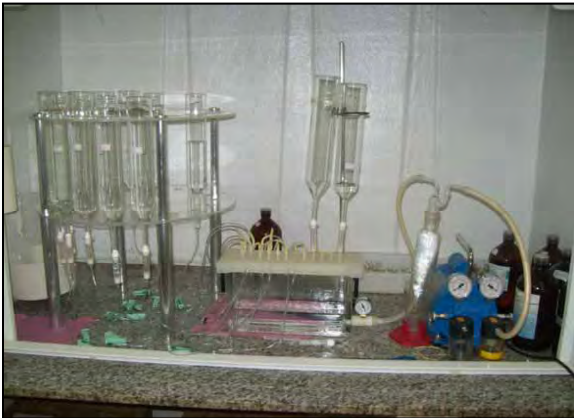
Figura 21: Suporte desenvolvido para a utilização completa do Manifold .
