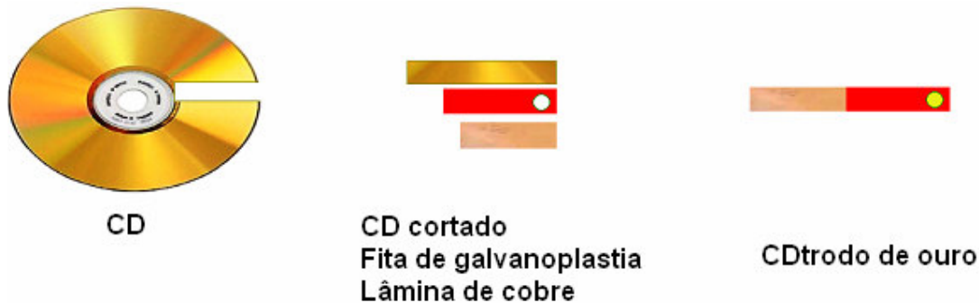
Figura 13. Esquema ilustrativo da confecção de CDtrodo de ouro com uso de fita de galvanoplastia.
