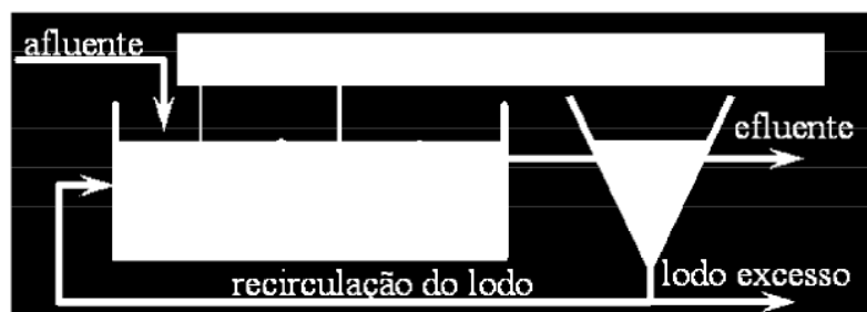
Figura 5 - Esquema do sistema de tratamento de esgoto por lodo ativado (COSTA, 2005).
