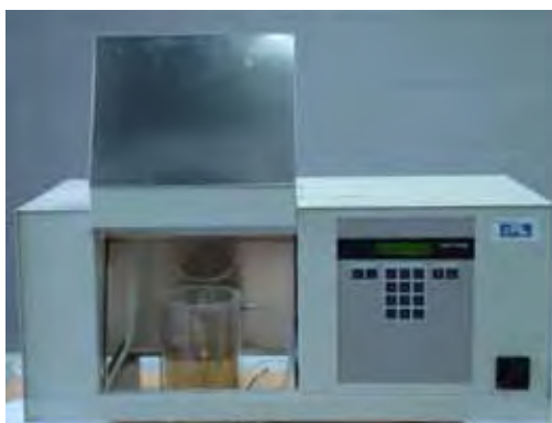
Figura 9. Foto do simulador solar utilizado nos experimentos de fotólise e foto-Fenton em escala de laboratório (Espanha).
