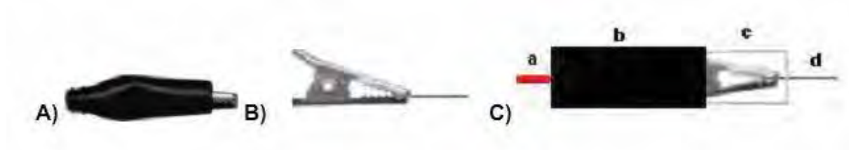
Figura 2 - Ilustrações do contato elétrico e da construção do eletrodo de trabalho. A) Garra jacaré original. B) Garra jacaré (sem a proteção de borracha), com a lâmina de trabalho fixada nos dentes. C) Aparência final do eletrodo, onde: a – terminal elétrico para conectar ao equipamento; b – corpo do eletrodo, devidamente isolado; c – região isolada com “parafilm” e d – lâmina exposta.
