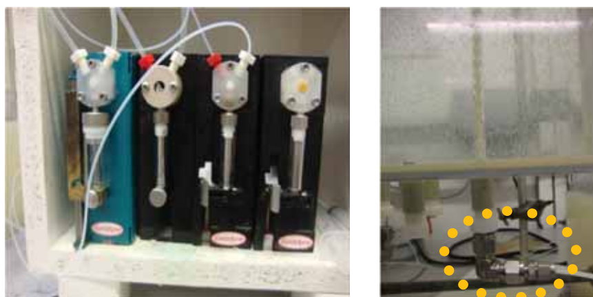
Figura 48 – OBR a) sistema de bombas oscilatórias em detalhe e b) tubo baffled reator imerso em banho térmico.
