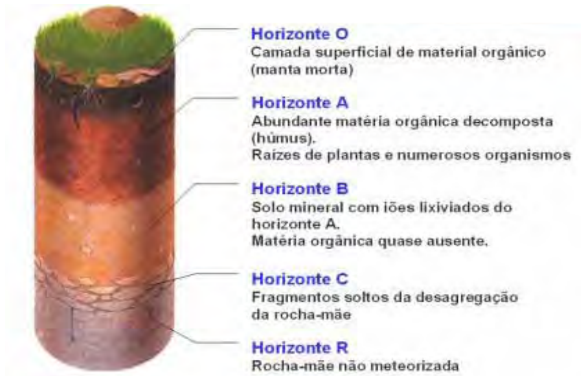
Figura 1.2 – Camadas de perfil genérico de solo.
