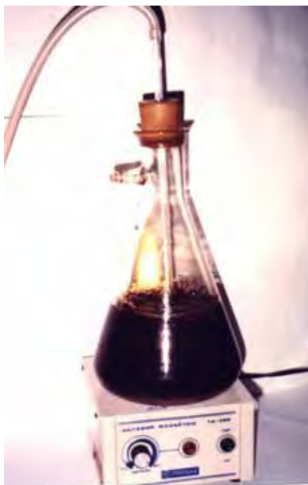
Figura 2.5 – Sistema extrator por batelada utilizado na extração de substâncias húmicas de solos da Bacia do Médio Rio Negro-AM e da região do Rio Aracá-AM.
