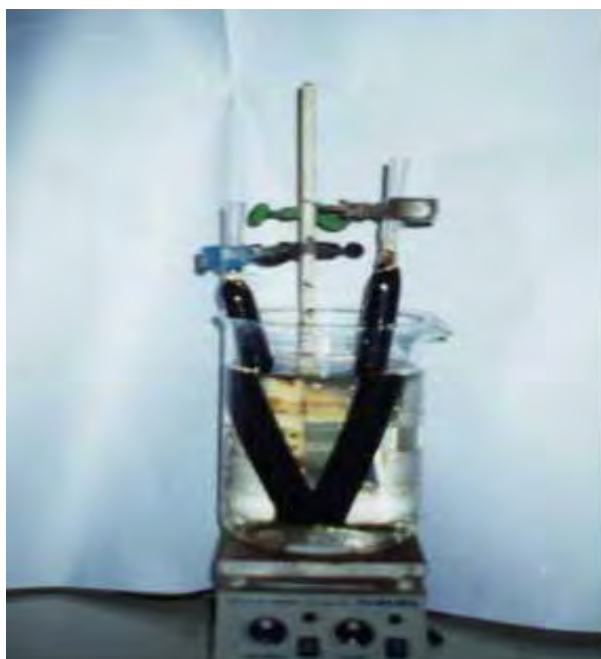
Figura 2.6 - Purificação de substâncias húmicas extraídas de solos da Bacia do Médio Rio Negro-AM e região do Rio Aracá-AM.
