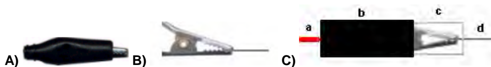
Figura 1: Ilustrações do contato elétrico e da construção do eletrodo de trabalho. A) Garra jacaré original. B) Garra jacaré (sem a proteção de borracha), com a lâmina de trabalho fixada nos dentes. C) Aparência final do eletrodo, onde: a – terminal elétrico para conectar ao equipamento; b – corpo do eletrodo, de material isolante (plástico); c – região isolada com “Parafilm” e d – lâmina exposta.
