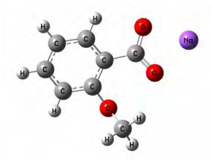
Figura 19. Modelo estrutural do Na(2-MeO-Bz) otimizado no programa Gaussian 98.
