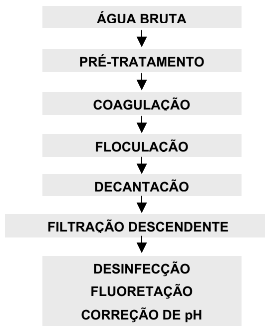
Figura 10 - Tecnologia de tratamento completo de água destinada ao consumo humano (DI BERNARDO, 1993).
