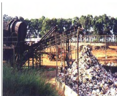
Figura 02d: peneira com malha de 4 cm
