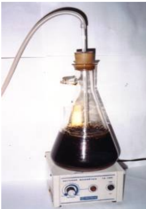
FIGURA 5 – Sistema extrator utilizado na extração das substâncias húmicas de solo por procedimento em batelada
