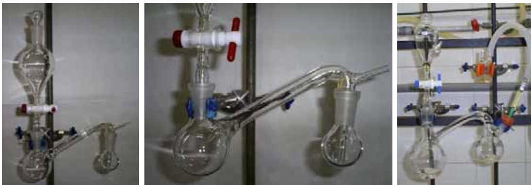
Figura 44 - Sistema de Kipp modificado para preparação dos cloridratos.
