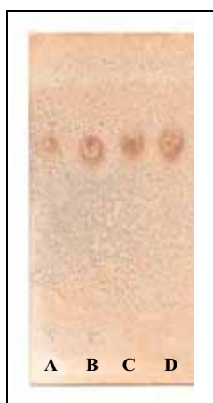
Figura 36 - CCD de 1 (A: base livre, B: cloridrato), 9 (C: base livre, D: cloridrato) (FE: sílica, FM: \text{CHCl}_3 :MeOH: \text{NH}_4\text{OH} (9:1:0,25) e revelador: ICIPt).
