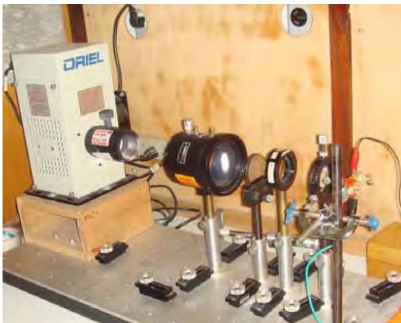
Figura II. 6. Banco óptico utilizado nas medidas de curvas I-V . Da esquerda para a direita: fonte de luz (lâmpada de Xe Oriel), filtro de água, filtros de densidade neutra, lente convergente e filtro AM1.5.
