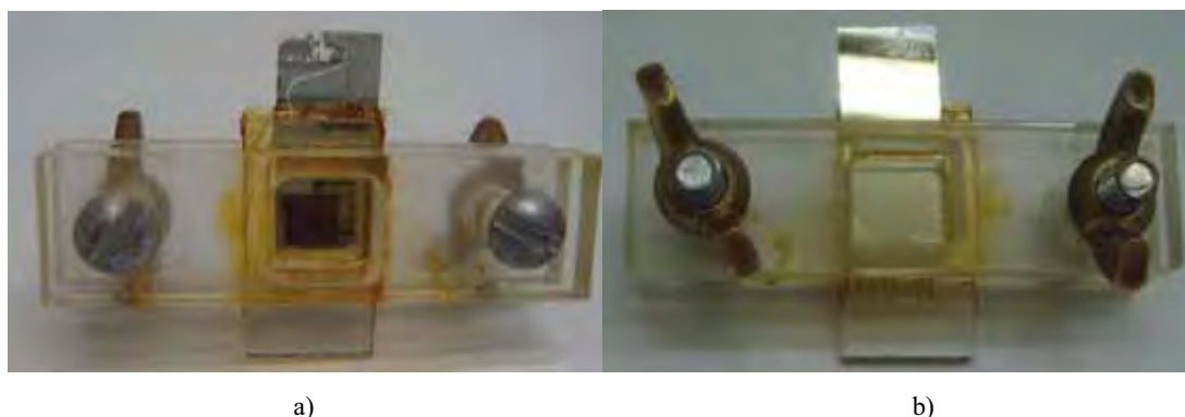
Figura II. 5. a) Imagem frontal de uma célula solar sensibilizada por corante não selada; b) imagem da parte de trás do dispositivo ilustrando que a utilização de um contra-eletródo de Pt espelhado depositado por sputtering limita a incidência de luz pelo eletródo de trabalho (iluminação SE – substrato eletrólito).
