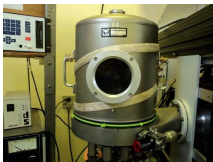
Figura 2. 4 Foto da câmara de sistema de alto vácuo utilizado para a deposição dos filmes.
