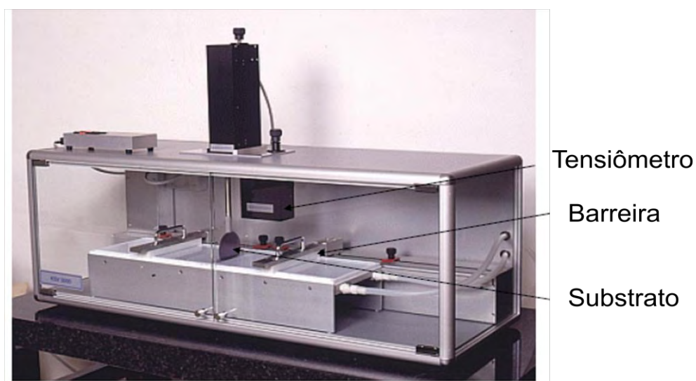
Figura 3. 1 Cuba de Langmuir-Blodgett KSV modelo 3000, utilizada para as medidas realizadas neste trabalho.
