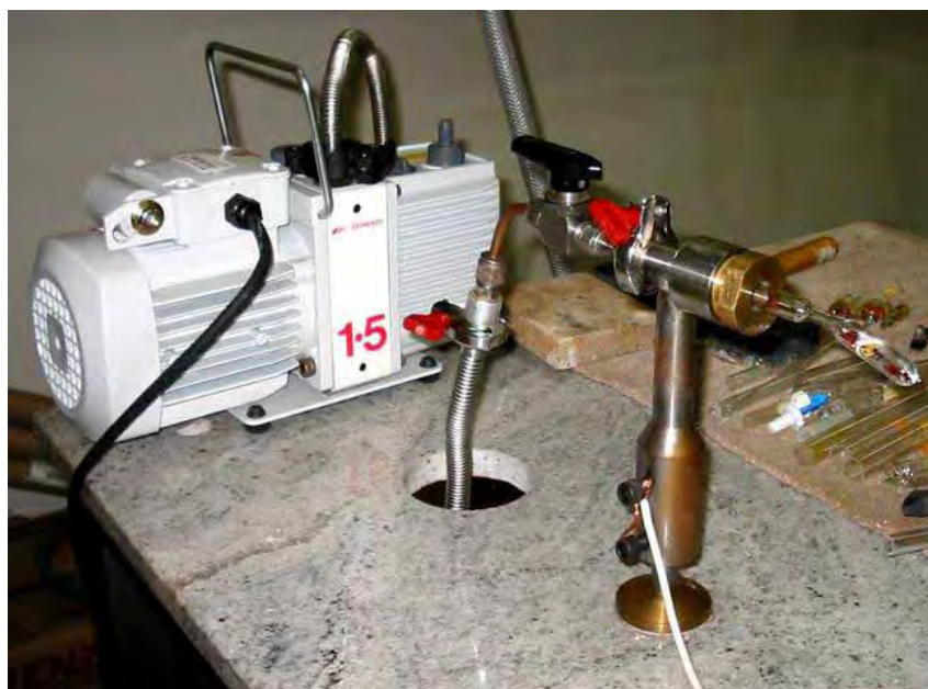
Figura 18. Imagem do sistema de pressão reduzida utilizado na síntese dos vidros calcogenetos.
