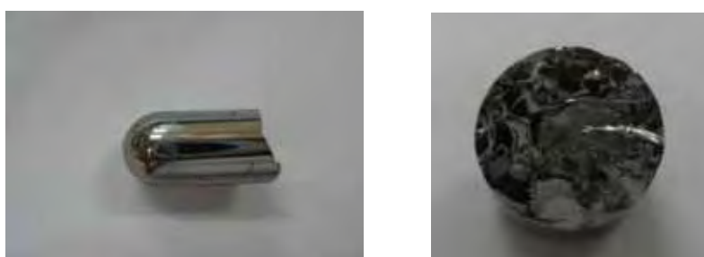
Figura 23. Imagem de uma amostra vítrea preparada no sistema Ga-Ge-Te.
