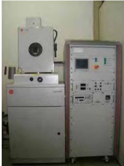
Figura 20. Imagem da câmara de evaporação da HHV Ltda., modelo Auto 500
