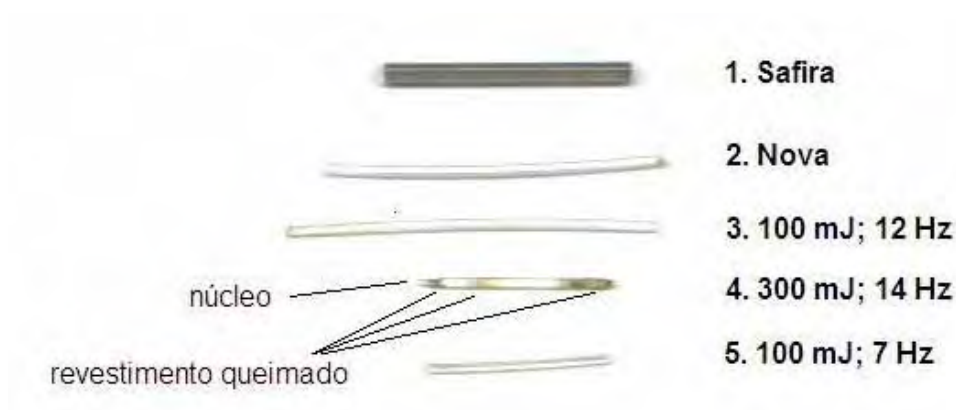
Figura 27 – 1. Ponta de safira. 2. Fibra óptica nova. 3. Fibra óptica após aplicação com combustão superficial do revestimento. 4. Fibra óptica após aplicação com combustão do revestimento. 5. Fibra óptica após aplicação e intacta..
