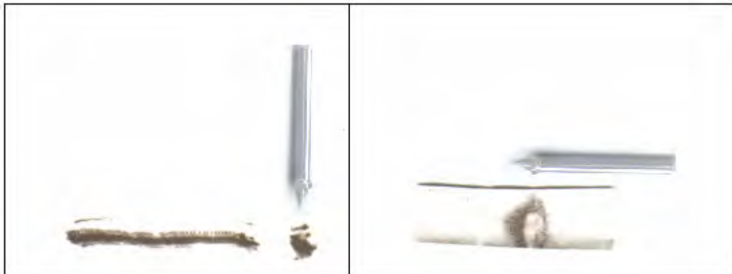
Figura 36 – Marcas deixadas pela ponta n°1. À esquerda devido a emissão frontal e à direita devido a emissão lateral da ponta. As linhas horizontais na figura da direita representam as bordas do papel.
