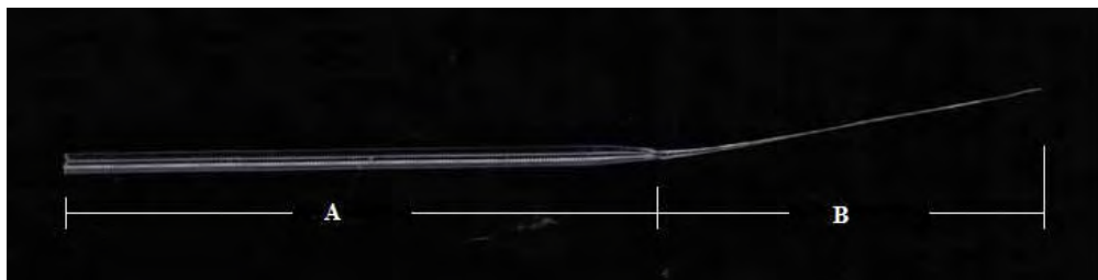
Figura 34 – Imagem obtida com scanner, de tubo capilar de 1,5 mm de diâmetro e comprimento 41 mm (trecho A), e fibra com 38 mm puxada manualmente (trecho B).
