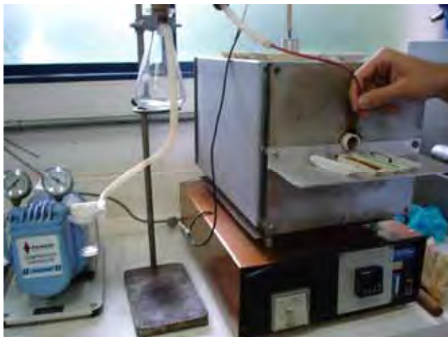
Figura 24 – Forno e sistema de aspiração dos vidros germanatos. Posicionamento vertical do capilar na mão do operador para aspirar o material fundido na navícula.
