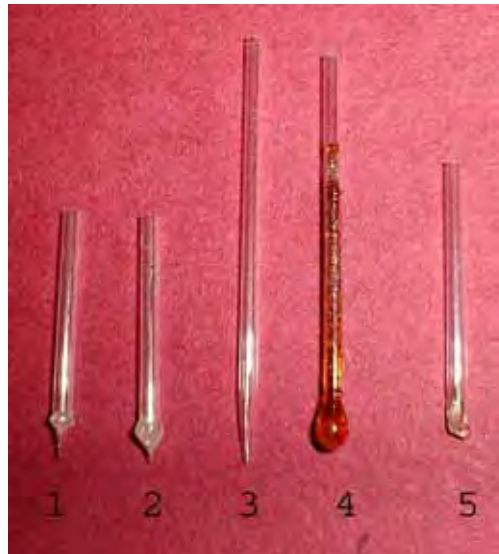
Figura 35 – Fibras de vidro germanato preparadas por soldagem (1,2 e 3) e aspiração (4 e 5).
