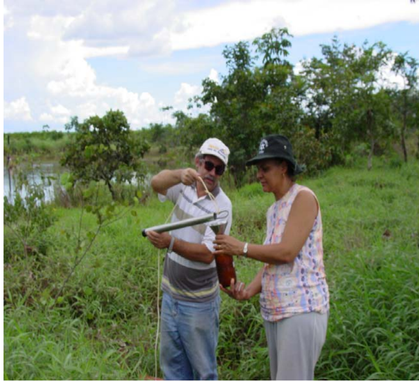
Figura 5 – Coleta de água de lençol freático de poço de monitoramento.
