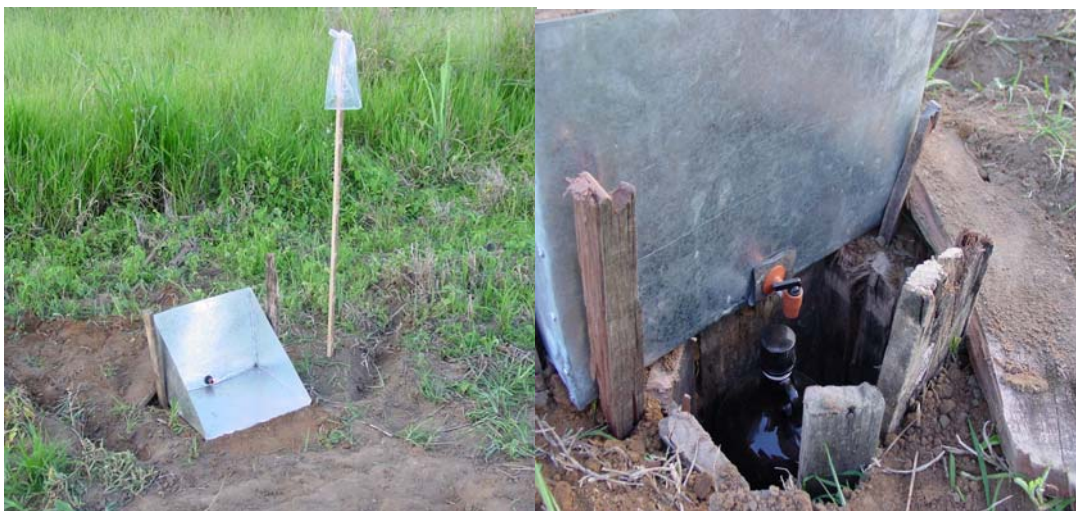
Figura 7 – Calha para coleta de água de escoamento superficial.
