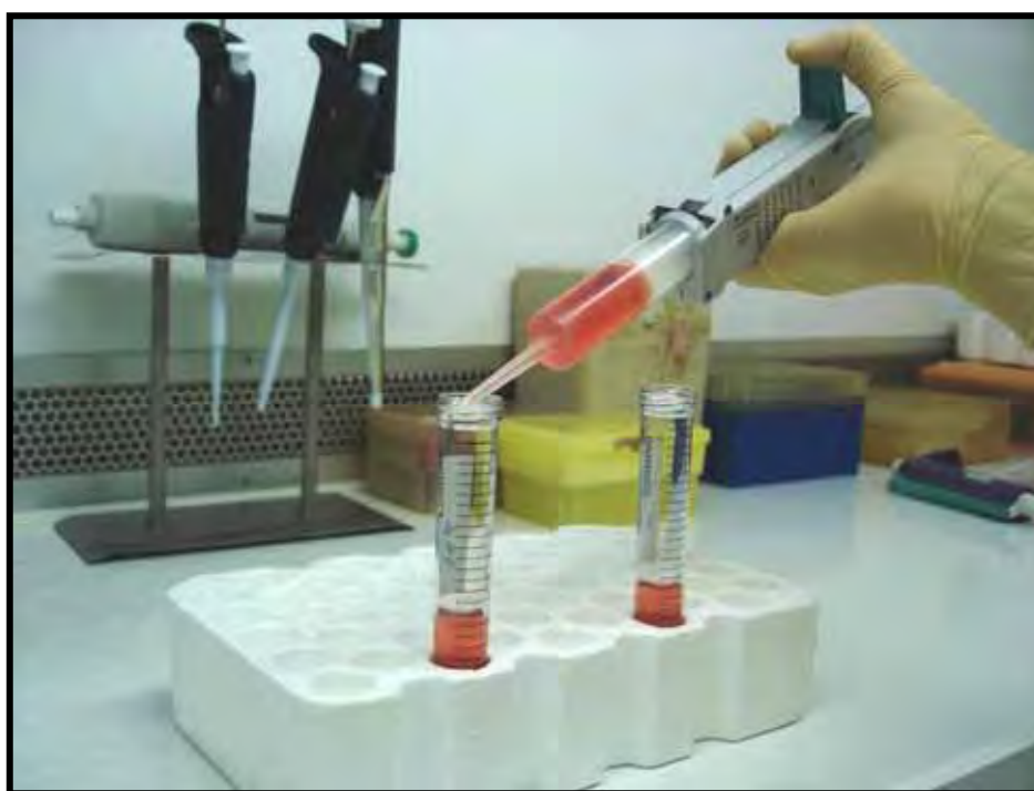
Figura 1. Montagem de um gradiente de densidade com auxílio de um pipetador de repetição.
