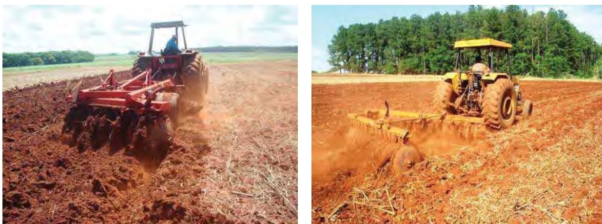
Figura 43- Manejo do solo com “grade pesada” 14 x 32” (esquerda) e com “grade leve” 32 x 20” (direita). Selvíria – MS, Brasil (2009/10 e 2010/11).
