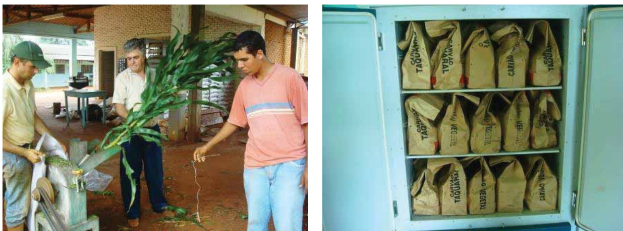
Figura 50- Fragmentação das plantas de milho em desintegrador forrageiro (esquerda) e secagem do material em estufa com renovação e circulação forçada de ar (direita). Selvíria – MS, Brasil (2009/10 e 2010/11).
