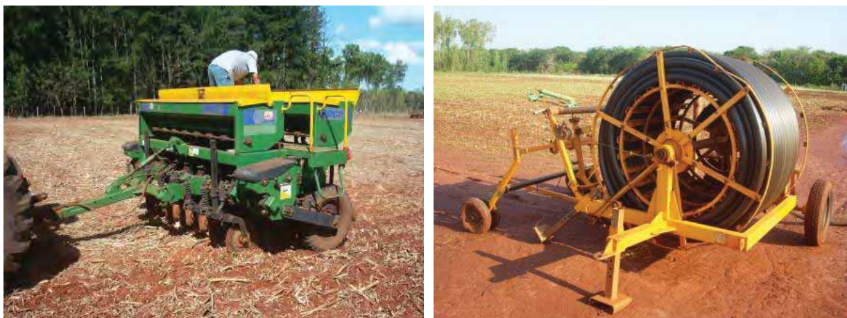
Figura 38- Semeadura das coberturas vegetais com semeadora específica para o sistema plantio direto (esquerda) e sistema de irrigação por aspersão do tipo “canhão” hidráulico auto-propelido (direita). Selvíria – MS, Brasil (2009/10 e 2010/11).
