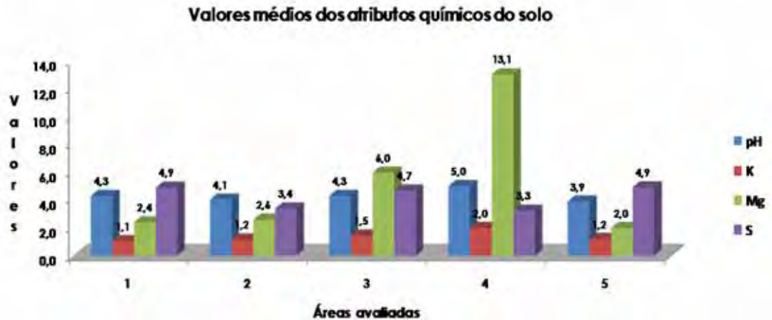
Figura 27. Representação gráfica dos valores médios encontrados para potencial hidrogeniônico (pH) ( \text{CaCl}_2 ), potássio (K) ( \text{mmol}_c \text{dm}^{-3} ), magnésio (Mg) ( \text{mmol}_c \text{dm}^{-3} ) e enxofre (S) ( \text{mg dm}^{-3} ), em áreas avaliadas da FEPE-UNESP, Selvíria-MS. Sendo 1: AAA; 2: AMA; 3: APA; 4: Mata ciliar e 5: Reserva legal.
