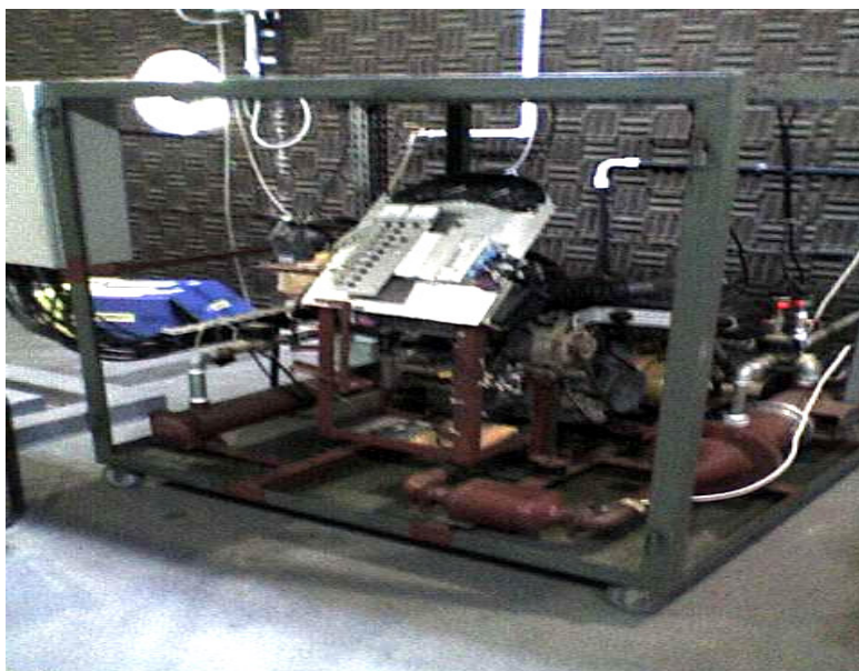
Figura 33 Protótipo 2 do sistema compacto de cogeração.
