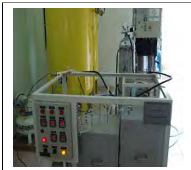
Figura 34 – Protótipo reformador de etanol: redução dos catalisadores.
