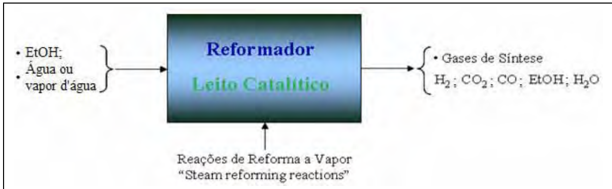
Figura 7 – Configuração para o processo de reforma a vapor externa – Reformador (SILVA, 2005).
