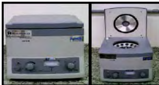
Figura 20. Centrífuga utilizada no ensaio de floculação.
