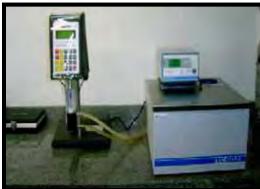
Figura 19. Viscosímetro rotacional do tipo Brookfield acoplado ao banho termostático.
