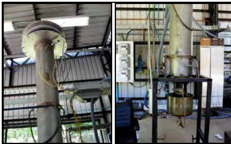
Figura 17. Foto da Câmara de Combustão, sendo a esquerda a parte superior e à direita a parte inferior.
