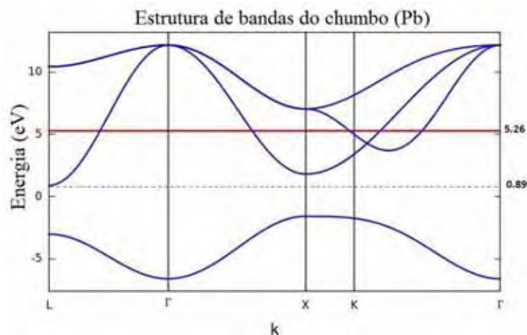
Figura 4.8: Estrutura de bandas do chumbo. A linha horizontal vermelha indica o nível de Fermi.
