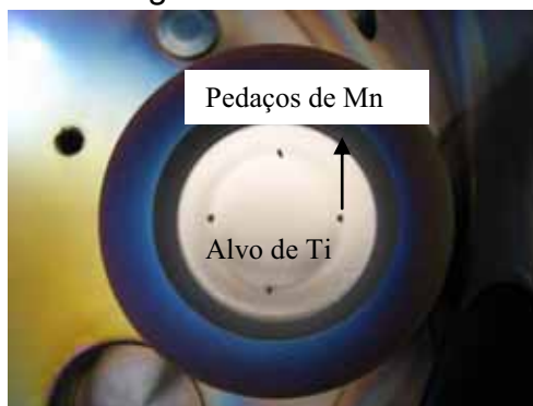
Figura 4.3 – Disposição dos pedaços de Mn sobre o alvo de Ti para o crescimento do filmes de Ti_{1-x}Mn_xO_2 ( x \sim 0,06 ).
