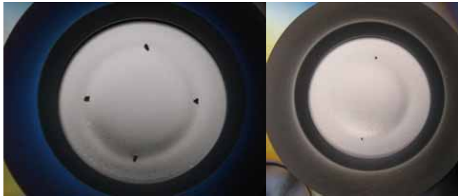
Figura B 1 – Alvo de Ti antes com ~2% de Mn (esquerda) e depois do processo de limpeza com ~0,016% de Mn (direita).
