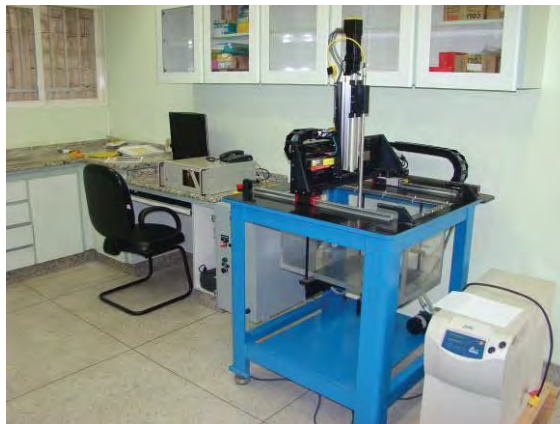
Figura 4.7 - Equipamento de ultrassom C-Scan por imersão em água.
