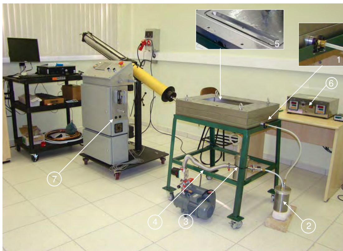
Figura 4.2 - Montagem do processo RTM
