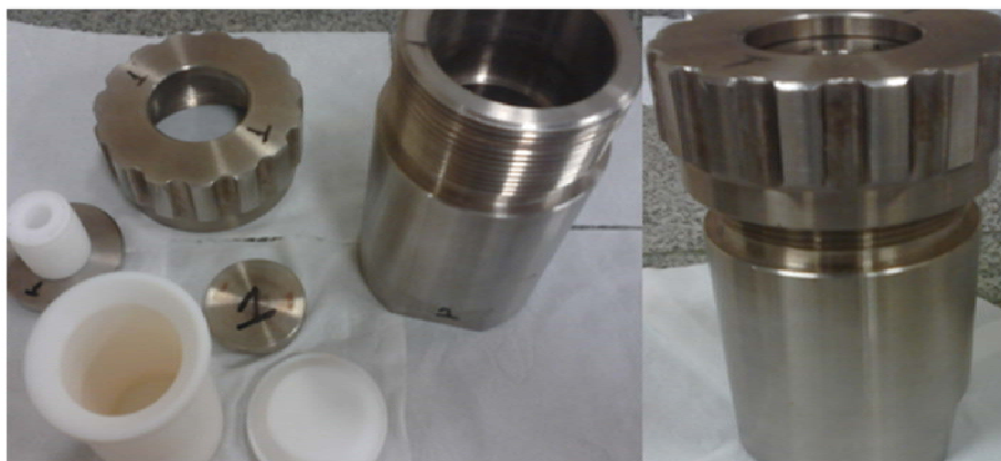
Figura 15 - Copo de teflon e reator metálico utilizado na síntese hidrotérmica.
