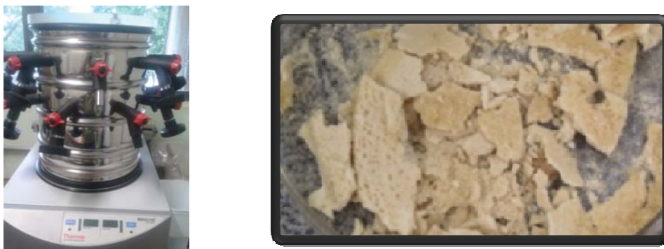
Figura 13 - Liofilizador L101 e Soro do leite liofilizado e hidrolisado enzimaticamente.
