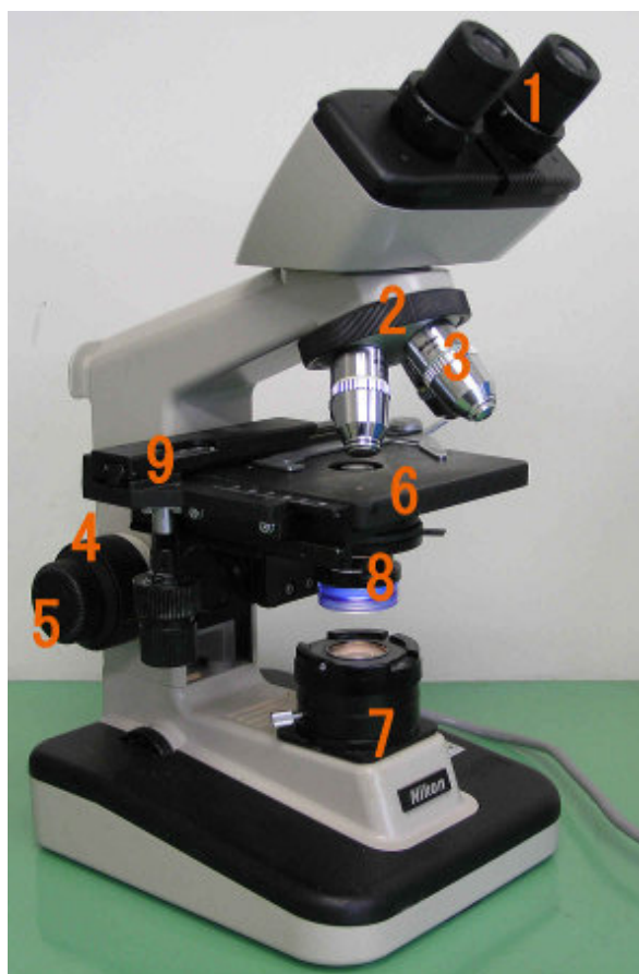
Figura 8. Microscópio Fotônico Convencional. (1) Lente ocular; (2) Revólver das objetivas; (3) Objetiva; (4) Parafuso macrométrico para focalização da imagem; (5) Parafuso micrométrico para focalização da imagem; (6) Mesa (onde a lâmina é colocada); (7) Fonte de luz; (8) Diafragma e condensador; (9) Sistema de parafusos para movimentação em dois eixos da mesa com a lâmina.
