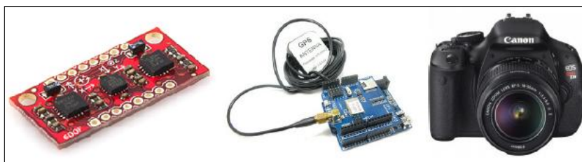
Figura 93 - Placa contendo uma IMU/MEMS ( www.sparkfun.com ) (esq.); receptor GNSS Shield acoplado à PCA com antena externa ( lojabrasilrobotics.blogspot.com.br ) (centro); câmera digital com lente de alta definição ( www.produtopia.com.br ) (dir.). Fonte: Melo (2012).
