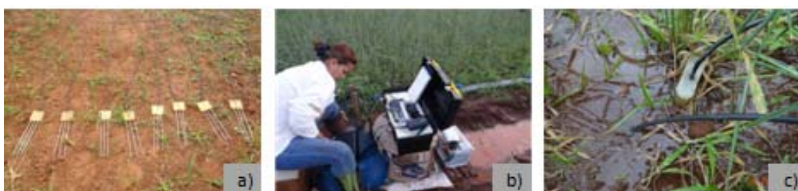
FIGURA 21- (a) Sondas contínuas de três hastes, (b) Medição do teor de água no campo com equipamento TDR100, (c) sondas instaladas no tabuleiro nas camadas de solo (0 a 20 cm) e (20 a 40 cm) de profundidade (Fonte: AUTOR).
