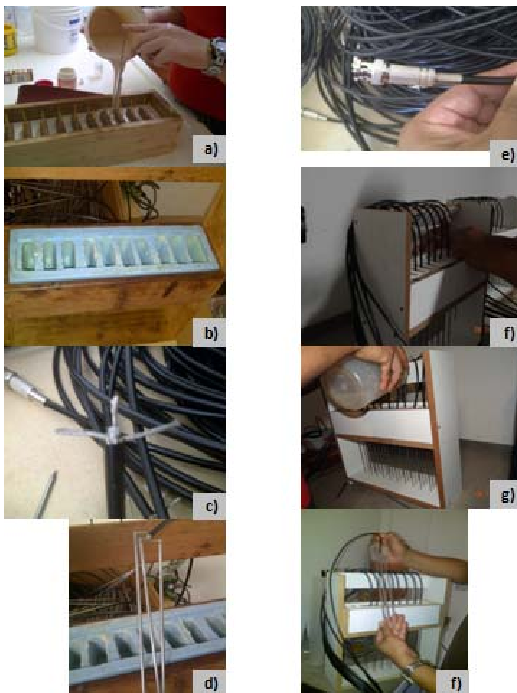
Figura 22- Construção de sonda contínua de três hastes, (a) fabricação do molde para as sondas a partir de borracha de silicone misturado com catalisador, (b) molde para construção de sondas após de 24 horas de secagem, (c) extremo com três pontas preparado do cabo coaxial RG 58 de 50 ohms, (d) extremo do cabo coaxial após da soldagem das três pontas às três hastes de 23, 5 e 24 cm de comprimento, sendo menor é o haste do centro, (e) extremo outro do cabo coaxial com conector BNC com mola e parafuso, (f) colocação do cabo com as hastes soldados dentro de cada molde, (h), aplicação da mistura de resina epoxi e endurecedor em cada molde, (g) Sonda de três hastes contínua pronta após de 8 horas de secagem (Fonte: AUTOR).
