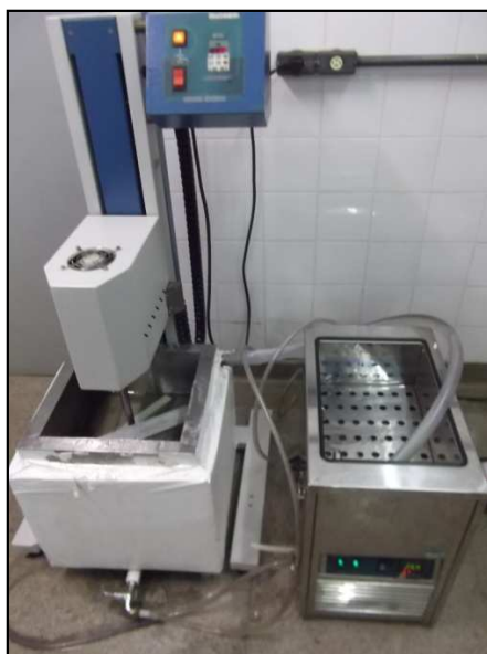
Figura 6: Equipamento utilizado na desidratação osmótica: cuba + banho termostático
