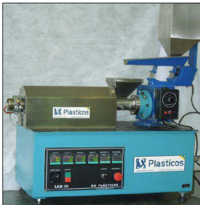
Figura 1: Extrusora de rosca única LAB 20 (AX Plásticos, Diadema – SP).
