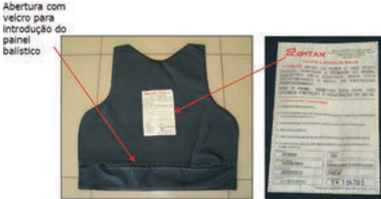
Figura 68. Capa externa do painel balístico frontal e detalhe da etiqueta.
