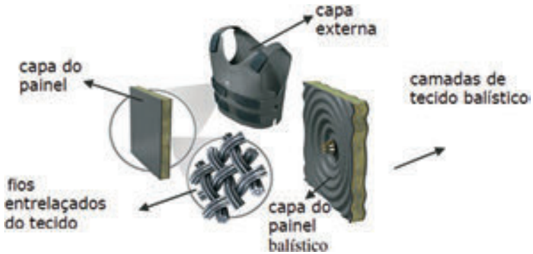
Figura 61. Partes componentes do colete balístico. Fonte: Revista mundo estranho .
