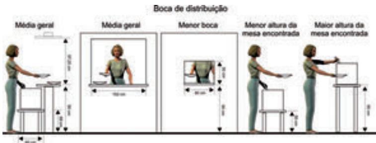
Figura 24. Altura do apoio para caldeirões e boca de distribuição.
