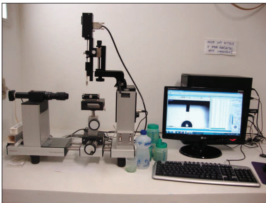
Figura 3. Tensiômetro automático modelo OCA-20 utilizado para avaliação do ângulo de contato entre a gota de água destilada e a superfície foliar de genótipos de couve.
