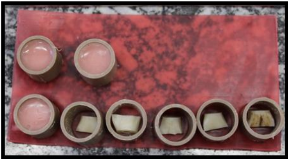
Figura 2 – Posicionamento dos fragmentos sobre placa de cera, posicionamento dos tubos de PVC e preenchimento dos tubos com resina acrílica auto-polimerizável.
