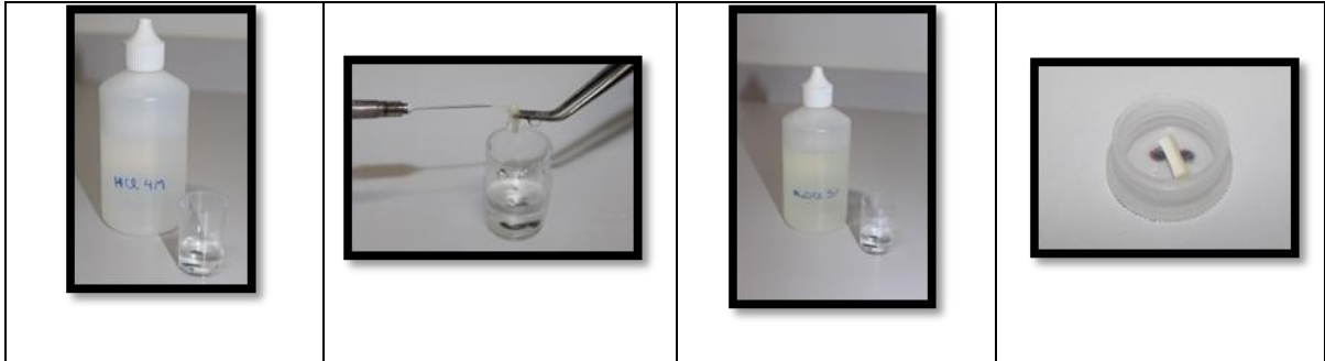
Figura 12 - Preparo das amostras para MEV: desproteínização com HCl 4M e descalcificação com NaOCl 5%.
