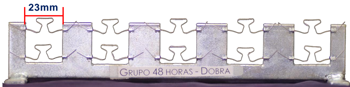
Figura 4 – Suporte utilizado para adaptação das molas nos diferentes tempos avaliados.
