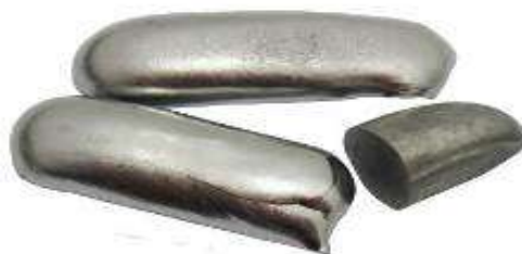
Figura 2 – Dois lingotes da liga Ti-35Nb-7Zr-5Ta inteiros e um lingote seccionado. Araraquara, 2013.
