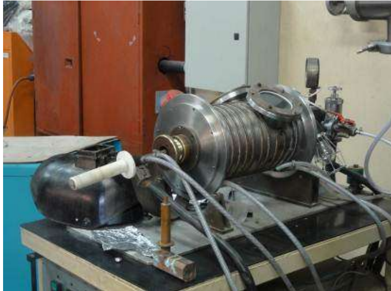
Figura 1 – Forno de fusão a arco-voltáico do Laboratório de Cerâmica e Tratamento de Minérios, da Escola de Engenharia de Lorena - EEL USP. Lorena, 2013.
