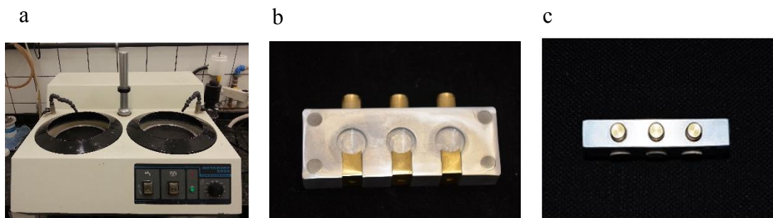
Figura 3 - a) Polidora mecânica Metaserv; b) Dispositivo metálico para polimento; c) Corpos-de-prova posicionados no dispositivo.
