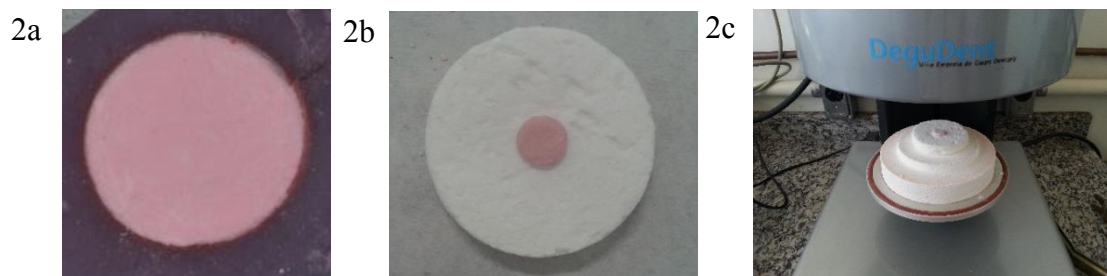
Figura 2 - a) Matriz de elastômero com porcelana VM9 aplicada; b) Espécime de porcelana VM9 na manta de revestimento rígida antes da sinterização; 2.c) Sinterização da porcelana VM9 em forno Alumini Press.
