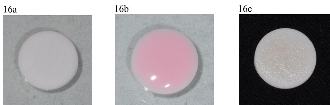
Figura 16 - a) Disco de zircônia sinterizada; b) Aplicação da camada de wash; c) Wash sinterizado sobre o disco de zircônia.
