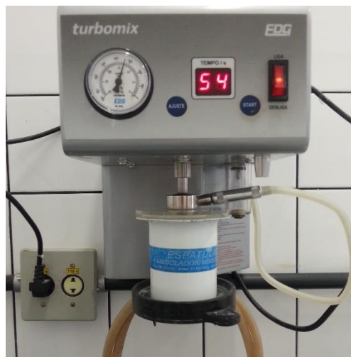
Figura 7 - Espatulação do revestimento à vácuo.
