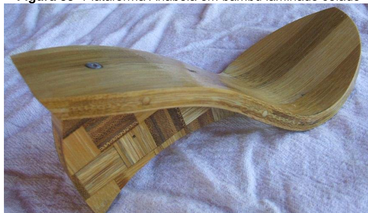
Figura 39- Plataforma Anabela em bambu laminado colado
