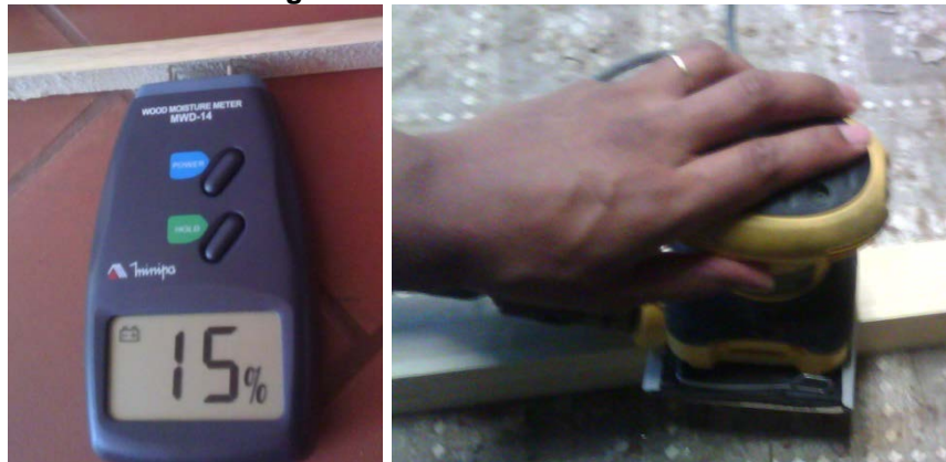
Figura 6 - Medidor de umidade e lixadeira
