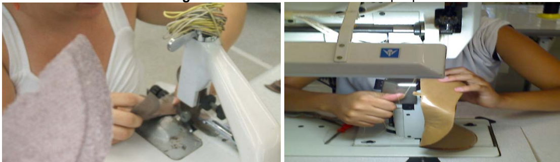
Figura 17 – Processos de chanfro e pesponto
