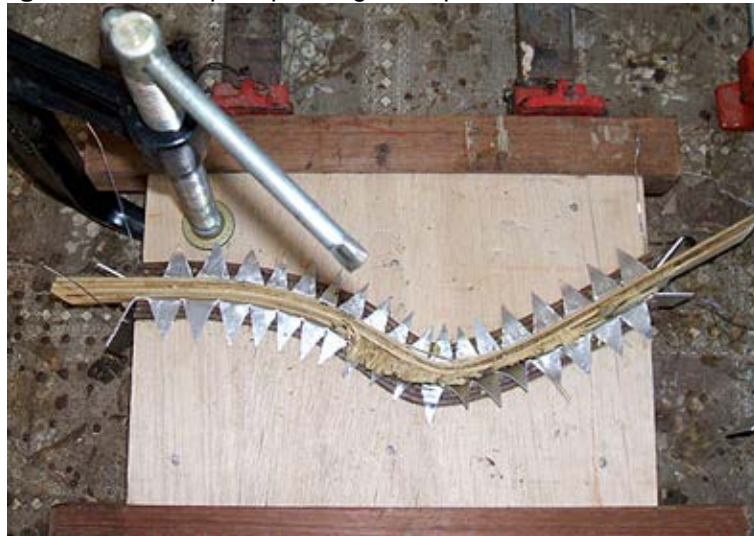
Figura 37- Molde para prensagem a quente das lâminas de bambu
