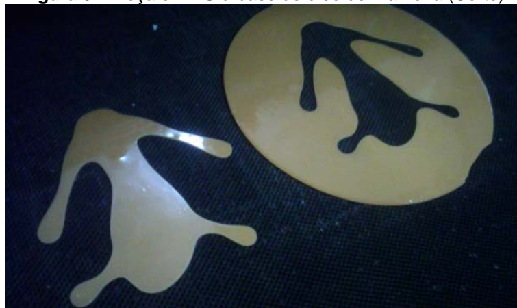
Figura 31- Peça em PU à base de óleo de mamona (Corte)
