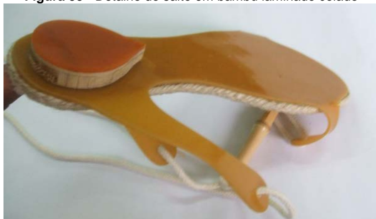
Figura 33 - Detalhe do salto em bambu laminado colado
