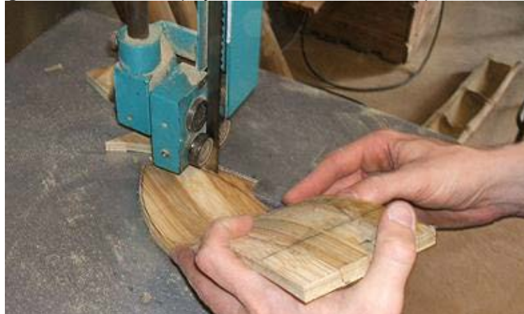
Figura 38- Recorte da peça de BLaC no formato da palmilha
