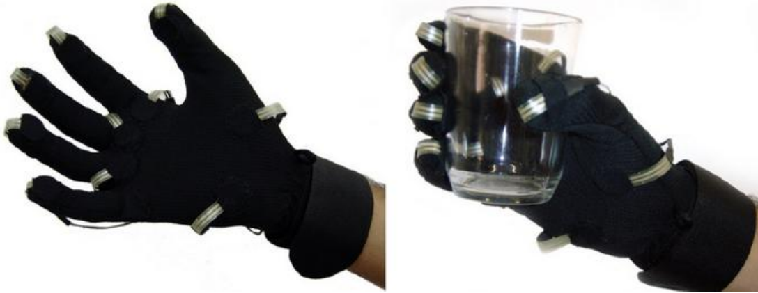
FIGURA 24: LUVA DOTADA DE SENSORES. FONTE: SILVA ET AL., 2008.
