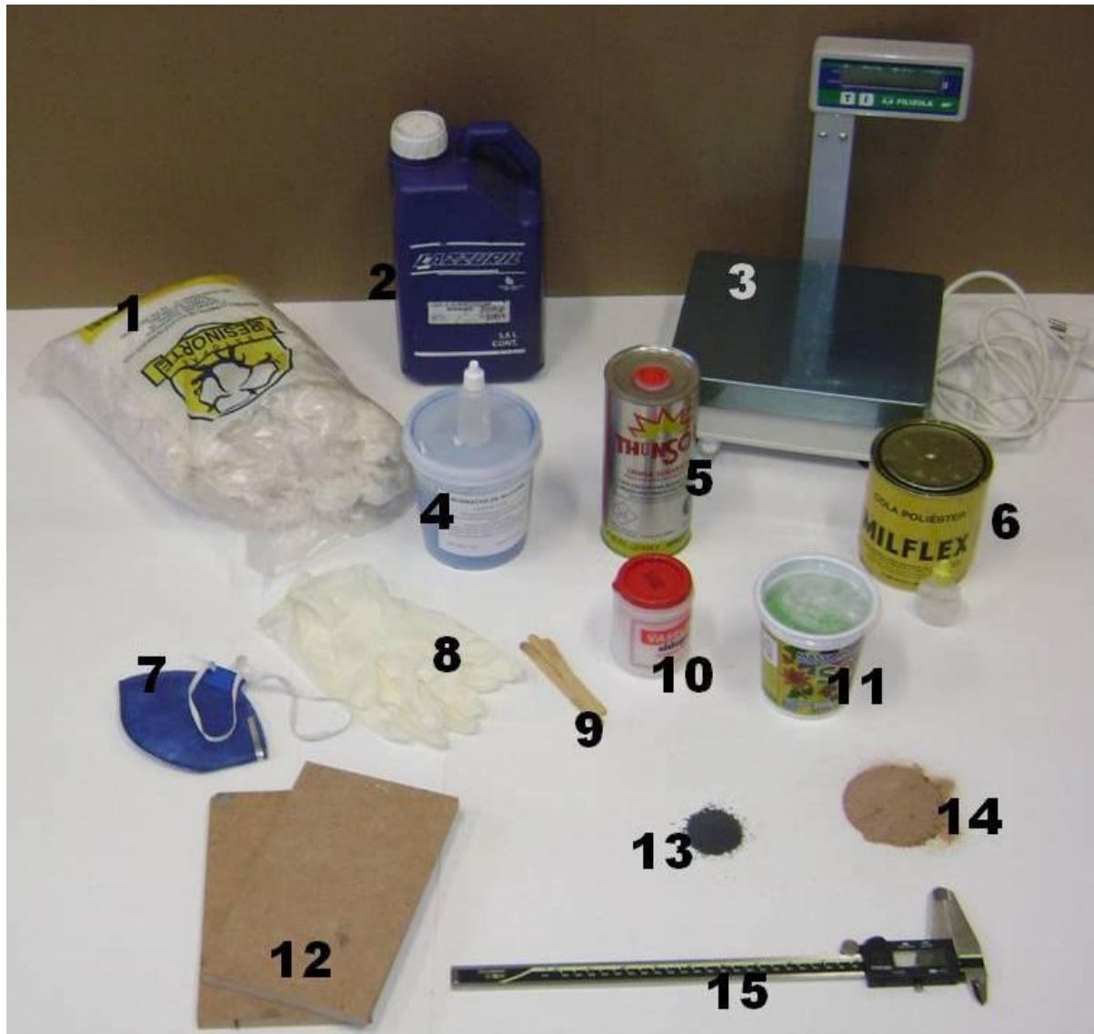
FIGURA 27– Materiais Utilizados: Estopa(1); Máscara para pintura (2); Balança (Digital Filizola Modelo MF-3/1) (3); Borracha de silicone(4); Solvente (5); Resina de Poliéster (6); Máscara (7); Luvas de silicone (8); Palitos de madeira (9); Vaselina sólida (10); Plastilina ou Massinha de modelar (11); Papel Foam (12); Micro esferas de ferro fundido (13); Areia (14) e Paquímetro (Digital de 300 mm/12"Absolute da marca Mitutoyo) (15).
