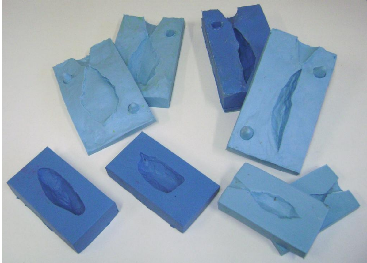
FIGURA 32 – Alguns Exemplos dos Moldes de Silicone Confeccionados
