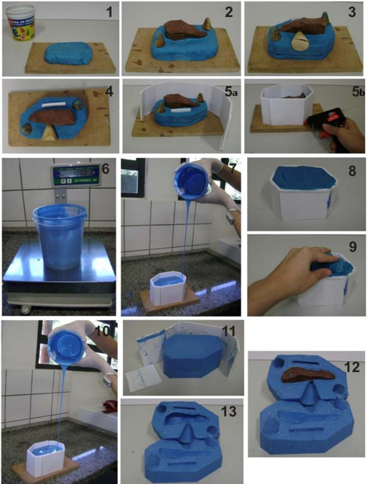
FIGURA 33 - ETAPAS DA EXECUÇÃO DOS MOLDES BIPARTIDOS
