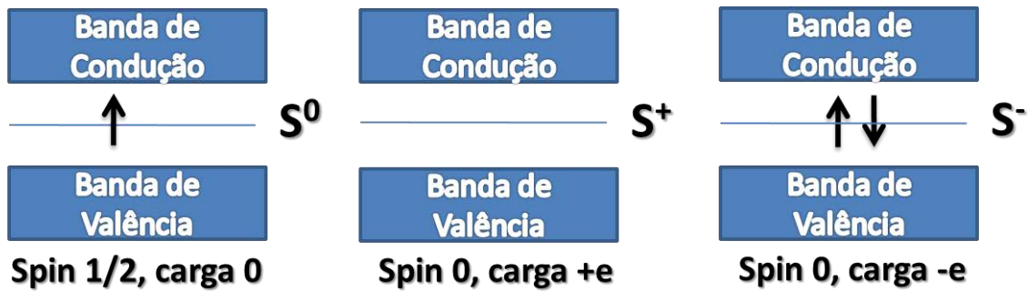
Figura 5 - Configuração das bandas de energia características de um sóliton.
