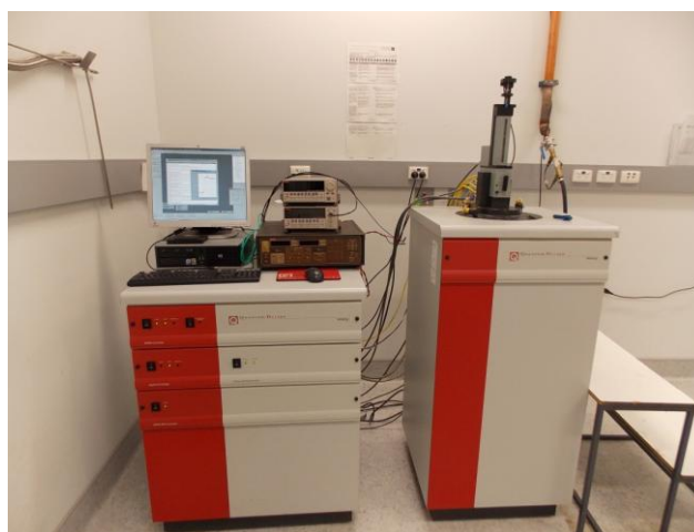
Figura 4.8: Equipamento MPMS-XL da Quantum Design utilizado nas medidas.
