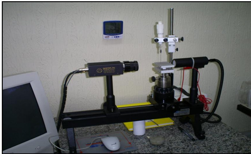
Figura 3.4.2: Foto do goniômetro modelo Ramé-Hart 100-00 utilizado para as medidas de ângulo de contato através do método da gota séssil.
