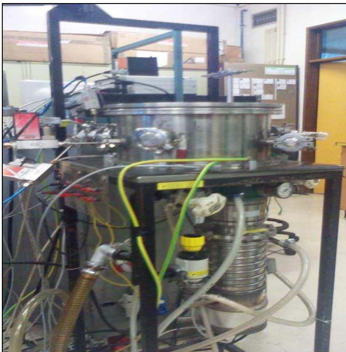
Figura 3.2.2.1: foto do sistema empregado na deposição de \text{TiO}_2 sobre os polímeros. Este sistema está instalado no LFF da Uminho, dedicado à técnica de Magnetron-Sputtering [1].
