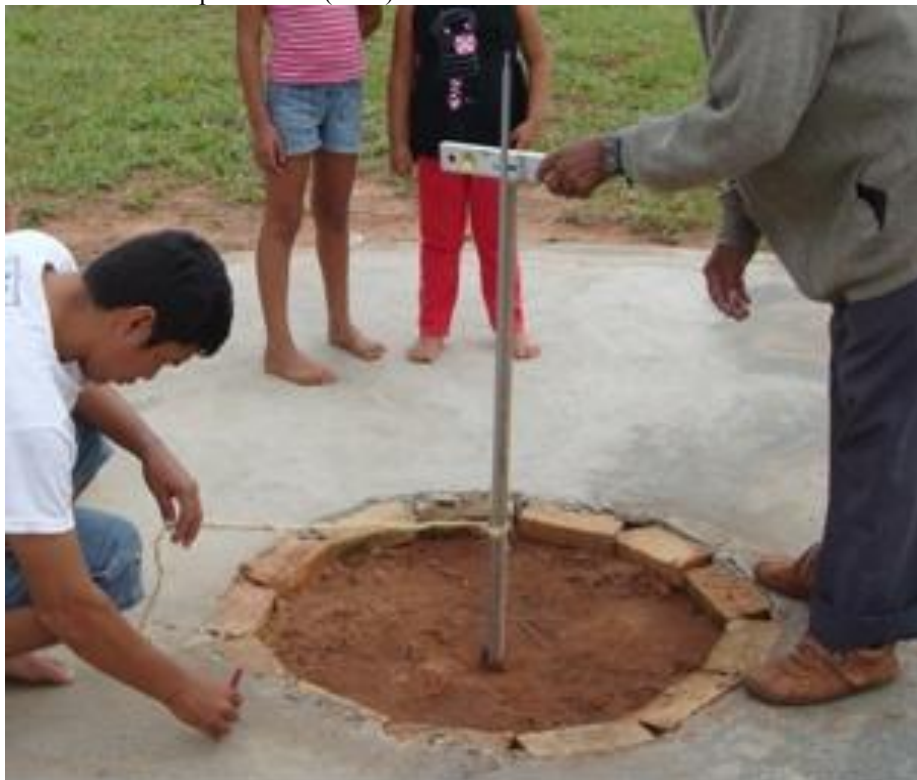
Figura 16 – Nivelamento do gnômon . Fonte: Elaborado pela autora (2013).
