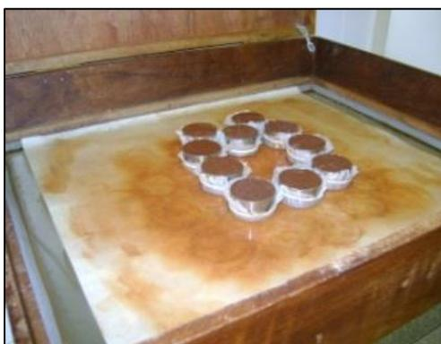
Figura 5. Determinação da porosidade do solo: drenagem das amostras previamente saturadas em mesa de tensão (- 6 kPa).
