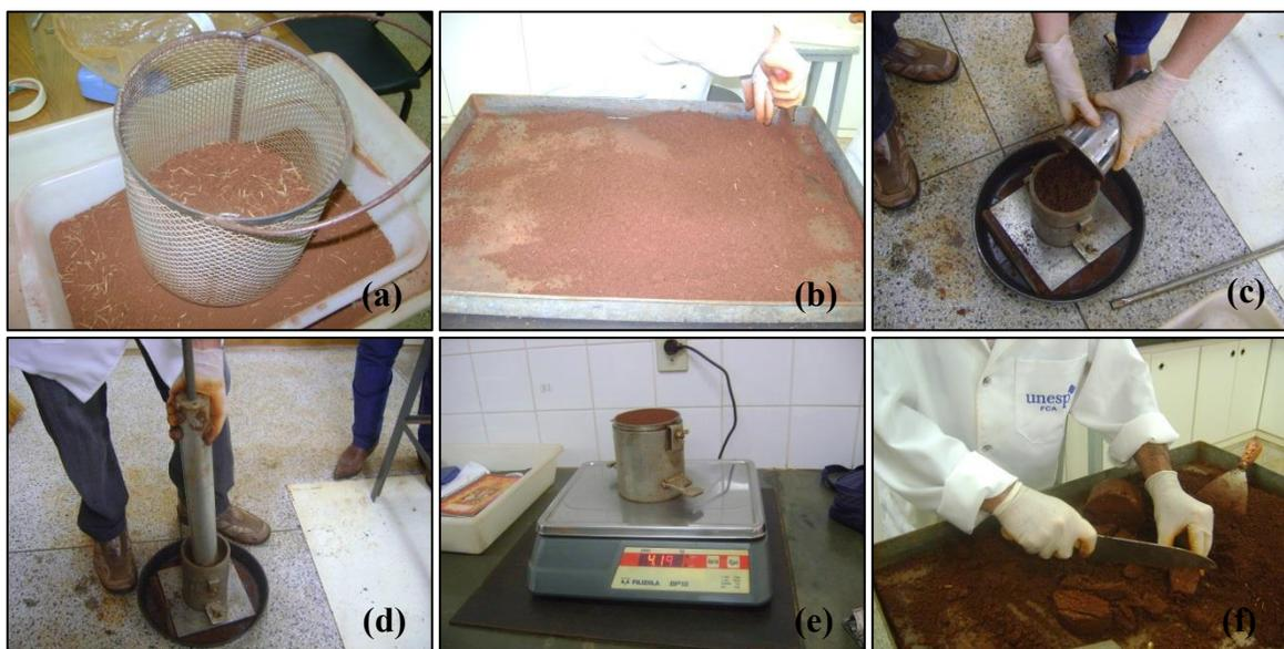
Figura 6. Ensaio de Proctor normal: peneiramento da amostra de solo (a); umedecimento da amostra (b); preenchimento do molde de ferro com o solo a ser compactado (c); processo de compactação do solo com auxílio de soquete (d); pesagem da amostra posteriormente ao processo de compactação (e); destorroamento da amostra e retirada de aliquota para determinação do teor de água do solo (f).
